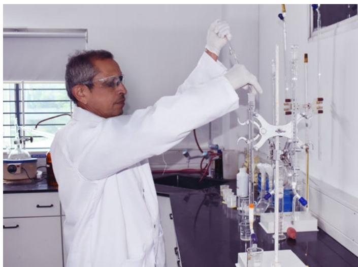
Ein Mitarbeitender prüft im Labor der Sorbchem India Silica-Material mit einem Farbstofftest.
